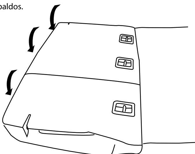
**3 Para instalar el revestimiento de carga en el Área reposacabezas trasero**
